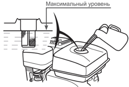
Рис. 12 Максимальный уровень топлива в топливном баке
