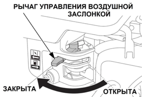
Рис. 14 Рычаг управления воздушной заслонкой (вид сверху)
