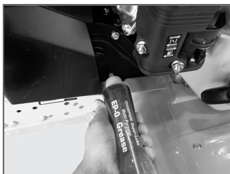
Рис. 25 Добавление смазки в редуктор
